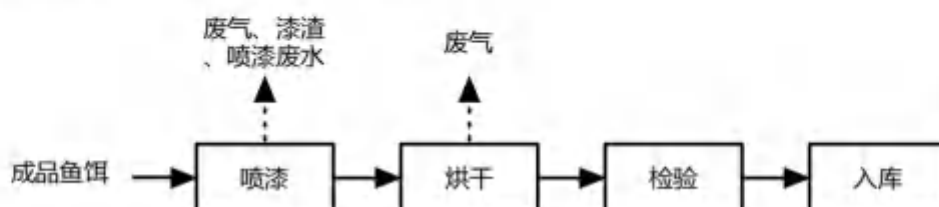
图 2-8 假鱼饵（金属）工艺流程图
